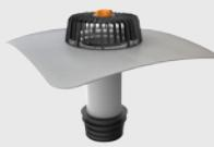
Sanační vpust TOPWET s integrovanou manžetou z hydroizolační fólie na bázi PVC s ochranným košem. Délka 400 mm, na zakázku možnost prodloužení až do 2000 mm.
