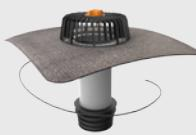
Sanační vpust TOPWET s integrovanou manžetou z modifikovaného asfaltového pásu s ochranným košem, vyhřívána 230 V s připojovacím kabelem. Délka 400 mm, na zakázku možnost prodloužení až do 2000 mm.
