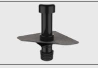
Sanační odvětrání TOPWET určené k napojení na potrubí odvětrání kanalizace s integrovanou manžetou z modifikovaného asfaltového pásu včetně dešťové krytky. Výška nad izolací 300 mm, hloubka pod izolací 200 mm, na zakázku možnost prodloužení až do 2000 mm.
