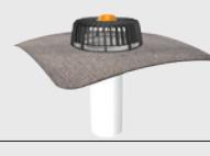
Střešní vpusť TOPWET pro nezateplené střechy s integrovanou manžetou z modifikovaného asfaltového pásu s ochranným košem. Vpusť lze zasunout do potrubí nebo otvoru až po hrdlo, ale má nižší odtokovou kapacitu. Délka 400 mm, na zakázku možnost prodloužení až do 1000 mm.
