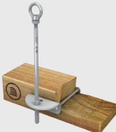
Nerezový kotvicí bod pro dřevěné nosníky. Kotvicí bod se skládá z úhelníku a sloupu o průměru 16 mm. Instalace probíhá pomocí dvou nerezových závitových tyčí uložených do předvrtných otvorů a zakontrováním matkami. Určeno pro dřevěné nosníky min. 100 x 120 mm.
