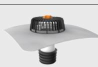
Sanační vpust TOPWET pro nezateplené střechy s integrovanou manžetou z hydroizolační fólie na bázi PVC s ochranným košem. Vpust lze zasunout do sanovaného potrubí až po hrdlo, ale má nižší odtokovou kapacitu. Délka 400 mm, na zakázku možnost prodloužení až do 1000 mm.
