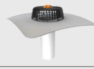
Střešní vpusť TOPWET pro nezateplené střechy s integrovanou manžetou z hydroizolační fólie na bázi PVC s ochranným košem. Vpusť lze zasunout do potrubí nebo otvoru až po hrdlo, ale má nižší odtokovou kapacitu. Délka 400 mm, na zakázku možnost prodloužení až do 1000 mm.
