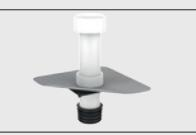
Sanační odvětrání TOPWET určené k napojení na potrubí odvětrání kanalizace s integrovanou manžetou z hydroizolační fólie na bázi PVC včetně dešťové krytky. Výška nad izolací 300 mm, hloubka pod izolací 200 mm, na zakázku možnost prodloužení až do 2000 mm.
