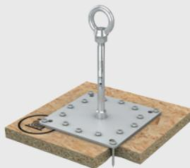
Nerezový kotvicí bod pro tenké dřevěné konstrukce. Kotvicí bod má základnu velikosti 200 x 200 mm a sloupek o průměru 16 mm. Instalace probíhá pomocí 16-ti nerezových samořezných šroubů připevněných do dřevěného bednění, případně OSB desky. Určeno pro bednění min. tloušťky 24 mm a OSB desky min. tl. 18 mm. Pro použití jako koncový a zlomový bod v systémech s nerezovým lanem je nutné jej doplnit ztužující trubkou.
