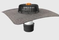
Sanační vpust TOPWET pro nezateplené střechy s integrovanou manžetou z modifikovaného asfaltového pásu s ochranným košem. Vpust lze zasunout do sanovaného potrubí až po hrdlo, ale má nižší odtokovou kapacitu. Délka 400 mm, na zakázku možnost prodloužení až do 1000 mm.
