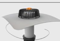
Sanační vpust TOPWET s integrovanou manžetou z hydroizolační fólie na bázi PVC s ochranným košem, vyhřívána 230 V s připojovacím kabelem. Délka 400 mm, na zakázku možnost prodloužení až do 2000 mm.
